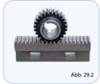
Lenkungsgetriebe mit Zahnstange, formula student / steering gear with gear rack, formula student
