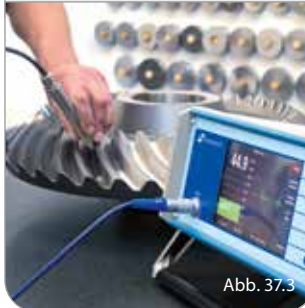
Schleifbrandprüfung (Barkhausenrauschen) Barkhausen Noise Analysis (BNA)
