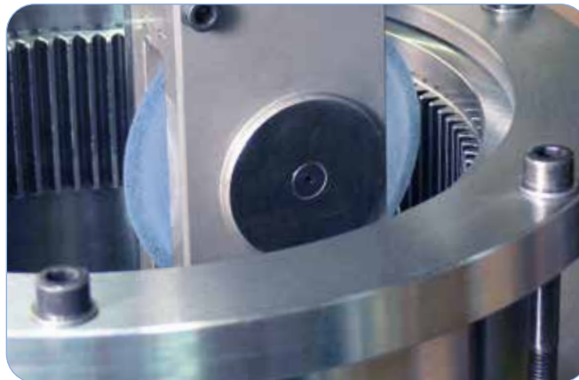
Innenverzahnung mit Schleifscheibe / internal gearing with grinding
