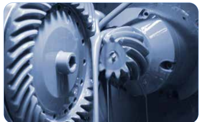
Radsatz beim Läppen auf der Maschine / gear set during machine lapping
