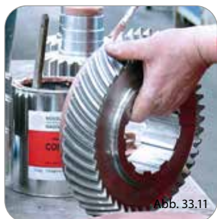
Auftragen einer Schutzmaske zum partiellen Härten / application of a protective layer for partial hardening
