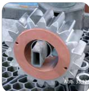
Auftragen einer Schutzmaske zum partiellen Härten / application of a protective layer for partial hardening
