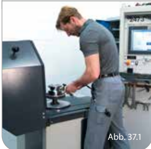
Wuchten vertikaler Bauteile vertical component balancing
