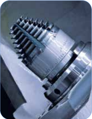
Palloidfräser eingängig / single-speed palloid milling cutter Abb. 12.2
