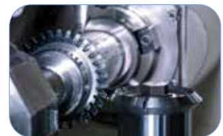
Teilwälzfräsen einer Geradzahnung / partial hobbing for a straight-cut gear
