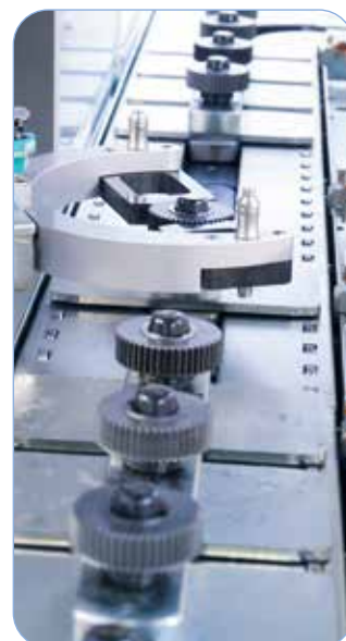
Automatische Beladung einer Wälzschleifmaschine / automatic loading of a gear grinding machine
