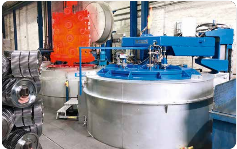
Einsatzhärten mit 1400 mm x 2000 mm (Durchmesser x Länge) / case hardening with 1400 mm x 2000 mm (diameter x length)
